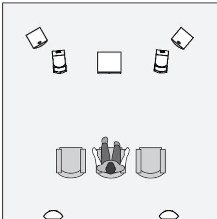
**Figure 13.** Enceintes EMESL à titre de canaux avant, la EM-C2 à titre de canal central, les enceintes EM-FX2 en tant que canaux ambiophoniques latéraux (effets) et les caissons de sous-graves Dynamo à titre de canal 0.1 (effets).
