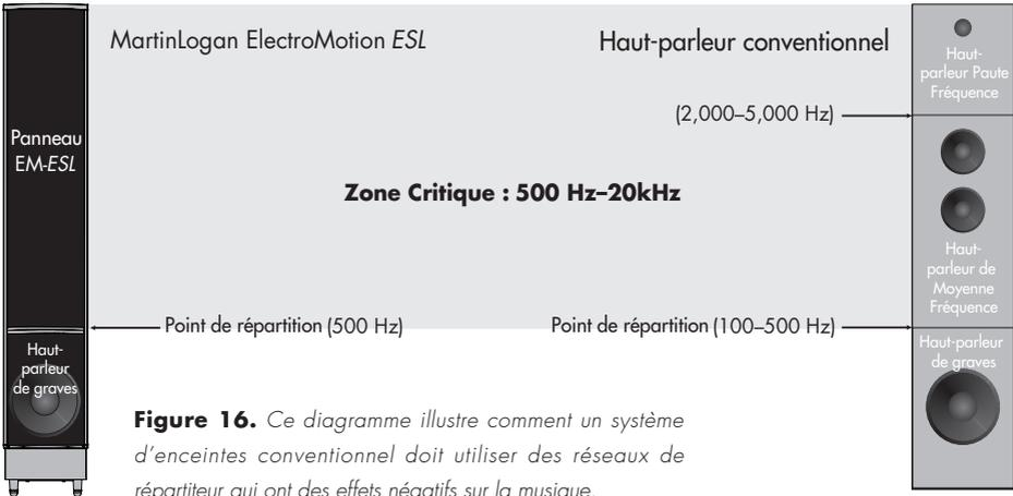
**Figure 16.** Ce diagramme illustre comment un système d'enceintes conventionnel doit utiliser des réseaux de répartiteur qui ont des effets négatifs sur la musique.
