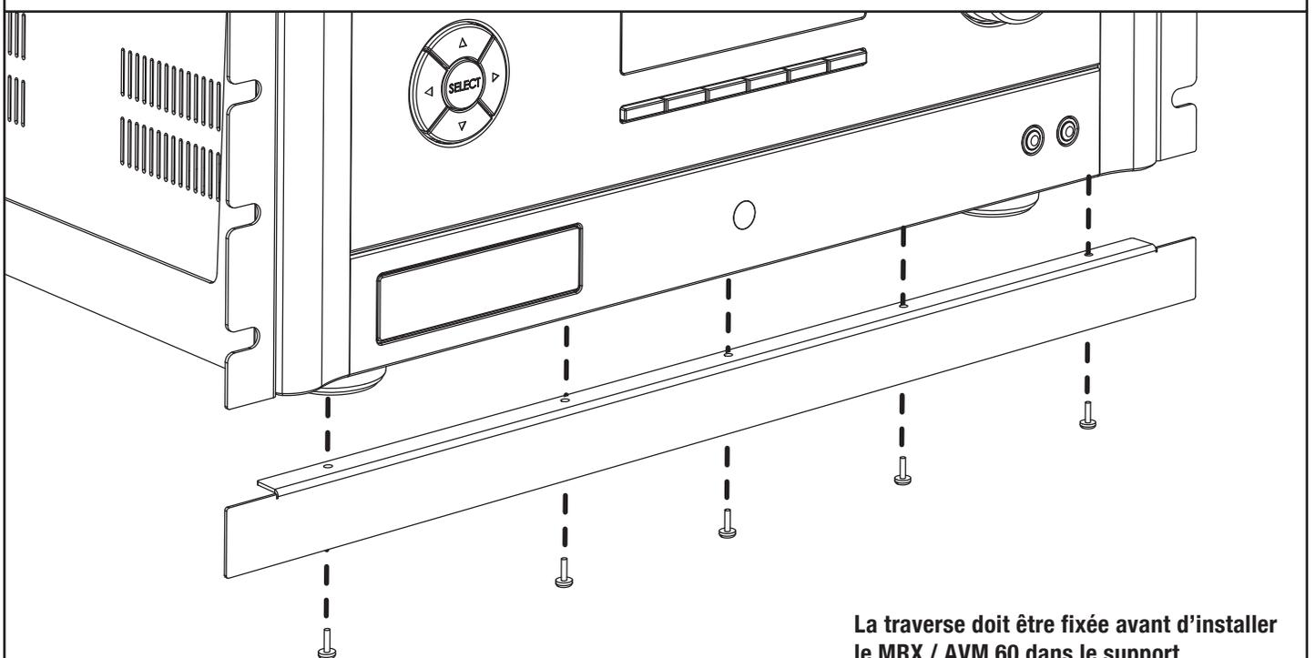
La traverse doit être fixée avant d'installer le MRX / AVM 60 dans le support.
