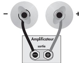
**Fig. 1b:** Raccord à un fil. Un canal illustré.
