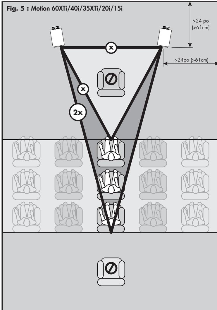
l'image et des détails sonores si vous pouvez placer les enceintes (mesure à partir du haut-parleur d'aigus et haut-parleurs de graves) en les positionnant de deux à trois mètres du mur avant et à deux mètres ou plus des murs latéraux (Fig. 5).
