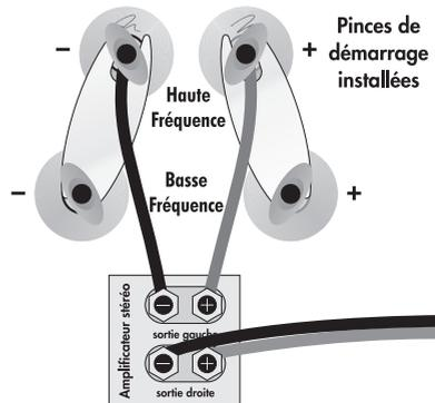
**MISE EN GARDE!** Seulement après avoir enlevé les pinces de démarrage, vous pouvez brancher les tracés de câble d'enceinte individuels de votre amplificateur aux bornes de raccordement du signal d'entrée de haute et de basse fréquence. Des dommages seront causés à vos amplificateurs si les pinces de démarrage ne sont pas enlevées.
