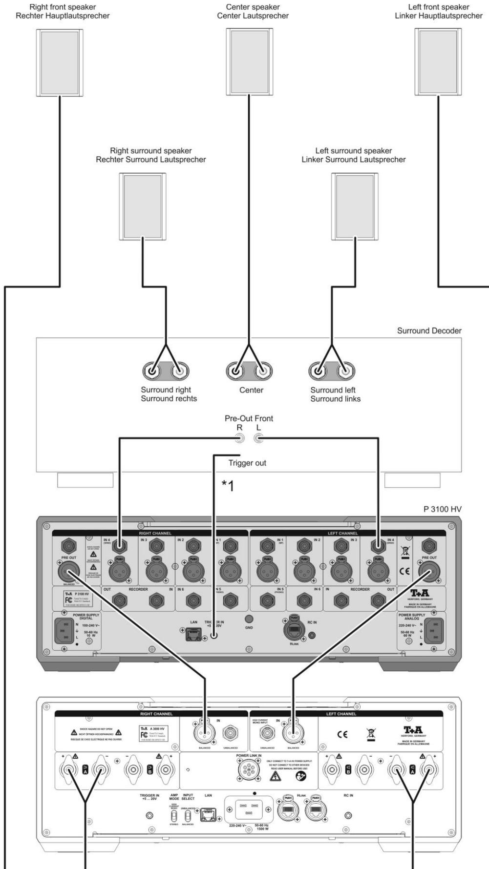
\*1 Triggerleitung optional / trigger connection optional
