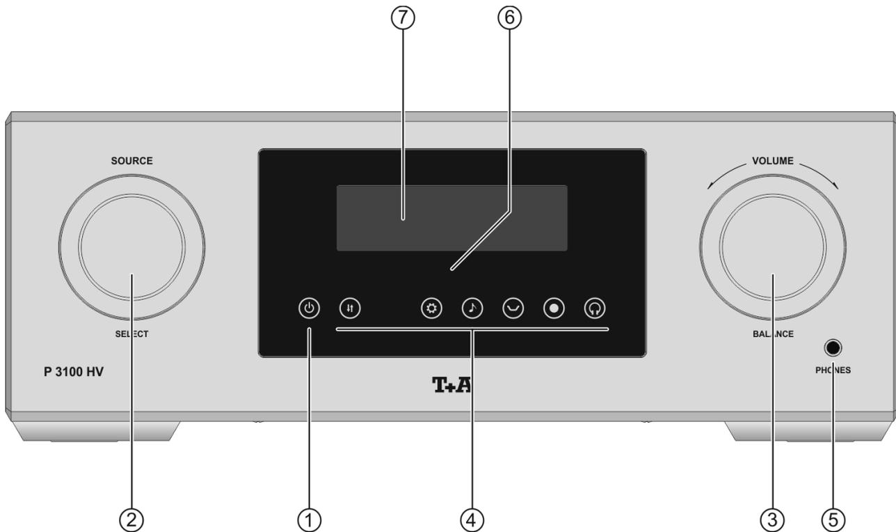
Mit den Sensortasten und Drehknöpfen an der Gerätefront können alle wichtigen Funktionen des **P 3100 HV** bedient werden. Für die Quellenwahl und Lautstärkeeinstellung stehen die großen Drehknöpfe zur Verfügung. Seltener benötigte Funktionen werden über ein Menü bedient, welches über die  $\odot$ -Taste aufgerufen wird.
