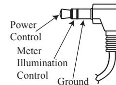
Figure 09– Power control (trigger) mini plug
